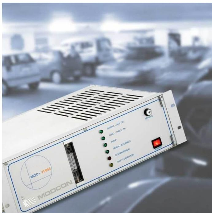
Измерительная эмиссионная система MOD-7500E разработана для непрерывного измерения уровня токсичности одно – или многокомпонентных газов в рабочей зоне. Прибор MOD-7500E представляет собой по размерам 19” стеллажный контейнер с размерами 132 мм по высоте и 340 мм глубиной и предназначен для монтажа в стандартный выдвижной шкаф. Прибор MOD-7500E имеет исполнение для измерения одного газа или может оснащаться для измерения многокомпонентных газов с сенсором O2.
